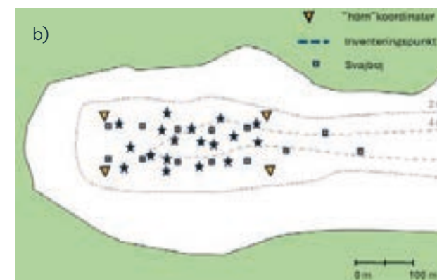
Figur 10b. Illustration av effektuppföljning med dropvideo-punkter i ett sammanhängande svajbojsområde, sk bojfält. Hörnkoordinater används för att markera ett undersökningsområde och underlätta utslumpning av punkter. Överst: inventeringspunkter har slumpats ut inom det utpekade svajbojsområdet före åtgärd. Nederst: uppföljning genom utslumpning av samma antal inventeringspunkter efter åtgärd.
