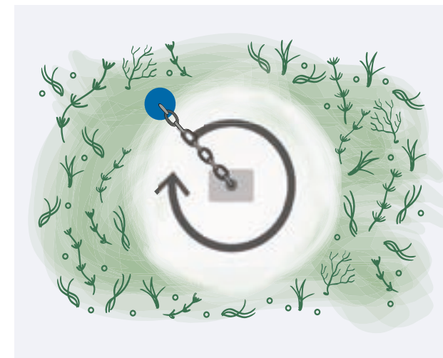
Runt bojstenar med kätting är botten ofta utan växtlighet eftersom kättingen, vars längd anpassats efter vattenståndet, släpar över botten vid lågvatten.
