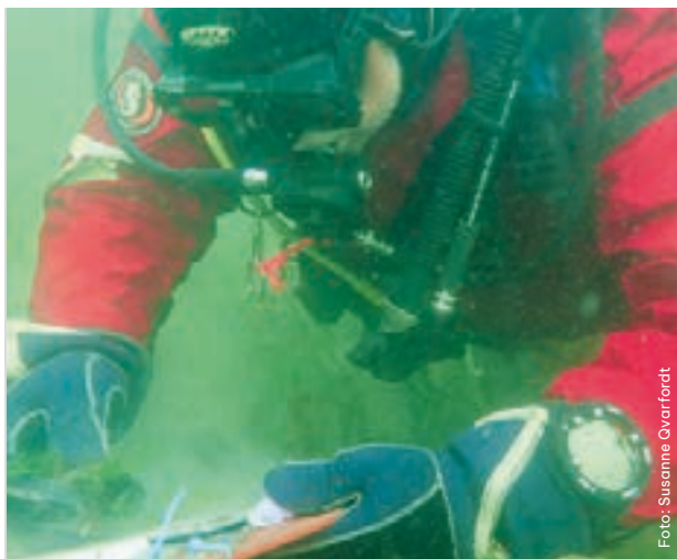
Figur 6. Illustration av effektuppföljning med dykmetoden i ett landförtöjningsområde. Vegetation och spår efter ankring inventeras på fyra inventeringstransekt som utgår från en bastransekt.
